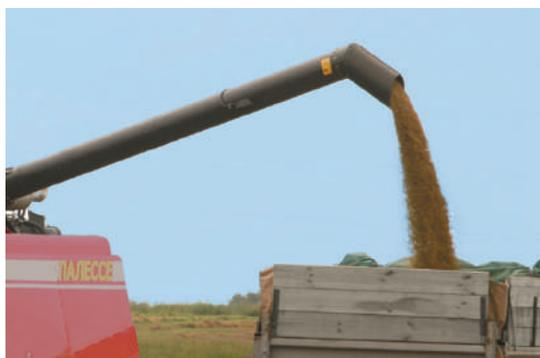
Система выгрузки зерна с верхним расположением выгрузного шнека позволяет быстро загружать зерном кузова автомобилей с высокими бортами, экономя время на уборке.
