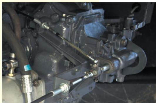
Новый тросовый механизм позволяет плавно и без усилий переключать диапазоны коробки передач, обеспечивая легкое и комфортное управление.
