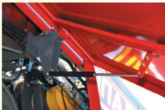
Эффективное решение по повышению удобства и сокращению времени на техническое обслуживание: полностью открываемые капоты, надежно удерживаемые пневмоцилиндрами, обеспечивают беспрепятственный и удобный доступ к узлам и механизмам комбайна.
