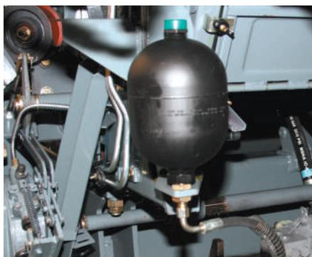
Применение гидропневмоаккумуляторов на гидроцилиндрах подъема/опускания наклонной камеры повышает качество копирования жаткой рельефа поля, предотвращает повреждение жатки и наклонной камеры.
