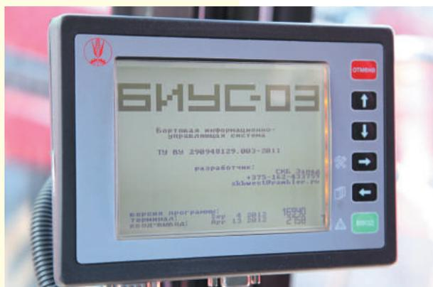
Бортовой компьютер при запуске автоматически проверяет цепи датчиков и механизмов на исправность, обеспечивает просмотр электросхемы с номерами цепей и советов по устранению неисправности.
