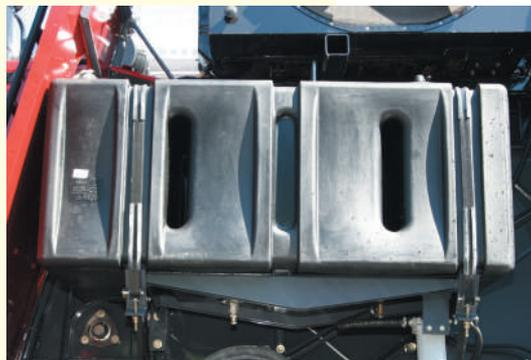
Применяемый в конструкции комбайна топливный бак емкостью 500 л изготовлен из высококачественных полимерных материалов, имеет преимущества в сравнении с металлическим топливным баком – долговечность и коррозионную стойкость. Является эффективным решением проблемы засорения топливной системы продуктами коррозии.
