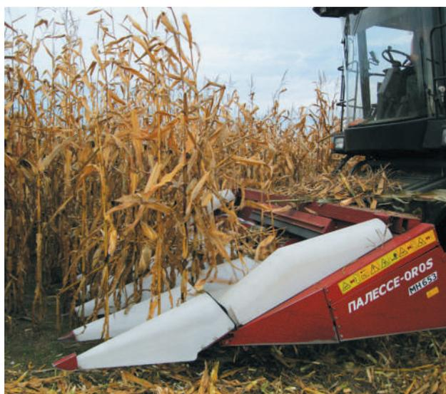
Для обеспечения качественной уборки кукурузы на зерно влажностью менее 25 % в конструкции комбайна предусмотрена возможность установки понижающего редуктора в приводе молотильного барабана. Применение редуктора позволяет эффективно убирать и другие легкотравмируемые культуры.
