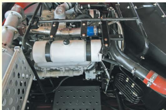
Надежный и экономичный двигатель ЯМЗ-236БЕ2-28 имеет достаточный резерв мощности для обеспечения стабильной работы комбайна. Верхняя площадка комбайна оборудована для безопасного и удобного проведения работ по техобслуживанию моторной установки.
