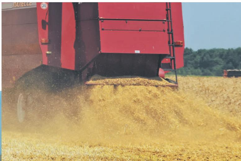
Соломоизмельчитель с увеличенным количеством ножей обеспечивает тщательную резку соломы и её равномерное рассеивание по полю на заданную ширину в качестве удобрения, создавая хорошую основу для будущего урожая.
