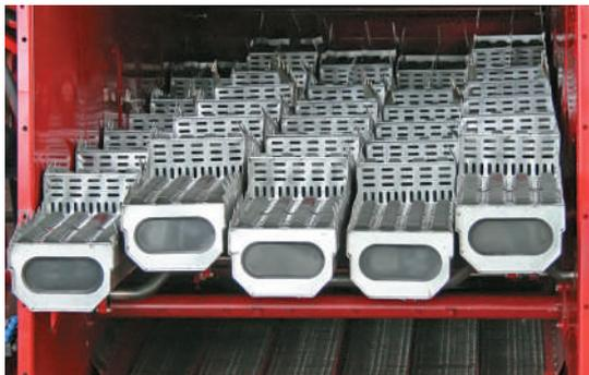
Наличие семи каскадов с оптимальным перепадом высот на каждой из пяти клавиш соломотряса и большая амплитуда встречного движения клавиш улучшают выделение зерна из соломистого вороха, поддерживают стабильную производительность и снижают потери.
