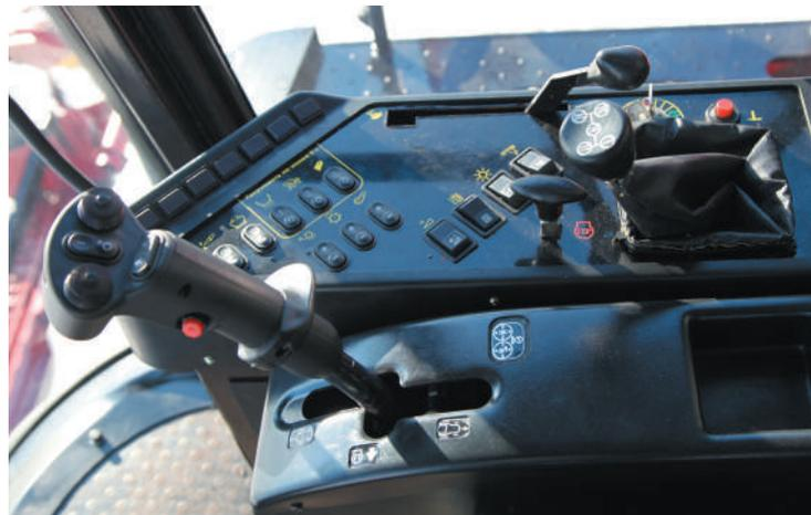
В обновлённом комбайне ПАЛЕССЕ GS10 ещё более функциональной стала рукоятка гидростата. К функциям, которыми можно управлять одной рукой и требующим быстрого принятия решений, кроме управления скоростью движения, положением мотвила и скоростью его вращения, положением наклонной камеры и моментального отключения её привода, добавилась ещё и возможность управления системой выгрузки зерна.
