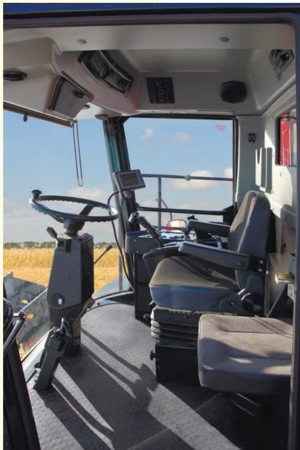
Кабина большого объема (2,6 м<sup>3</sup>), с панорамным стеклом, оснащённая кондиционером (по заказу - отопителем), полностью регулируемое рабочее кресло оператора и удобное откидное сиденье инструктора – это настоящий деловой комфорт на высоком уровне.
