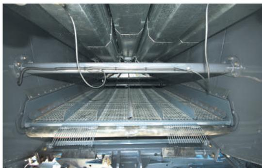
Трехступенчатая система тонкой очистки с электрорегулировкой интенсивности воздушного потока из кабины гарантирует высокую чистоту бункерного зерна.
