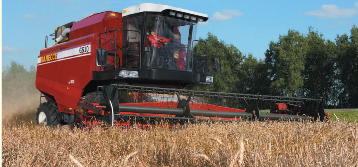
Комбайн ПАЛЕССЕ GS10 по пропускной способности занимает в линейке зерноуборочной техники ПАЛЕССЕ место между моделями GS812 и GS12. Машина с 250-сильным двигателем и молотилкой шириной 1500 мм ориентирована на потребности хозяйств со средней урожайностью, к которым относится абсолютное большинство российских сельхозпредприятий. При этом эксплуатационные качества комбайна дают ему необходимую гибкость, делающую применение GS10 эффективным в расширенном диапазоне урожайности.
